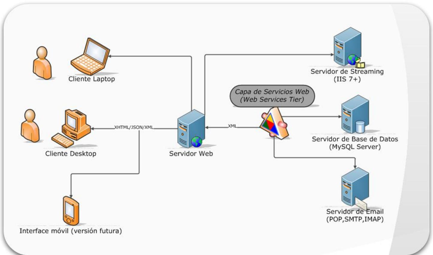
Figura III: Arquitectura de Aplicación e-Muni
